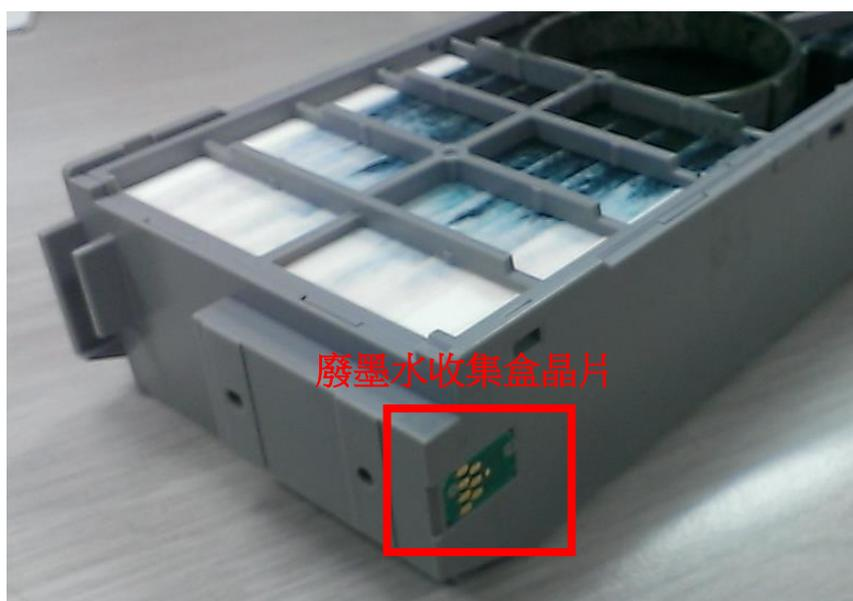
步驟 3、擦拭完後，將廢墨水收集盒安裝回至印表機中，確認機器是否正常(如下圖)，若依上述方式仍無法改善，建議可再更換新的耗材「廢墨水收集盒」再測試之。
