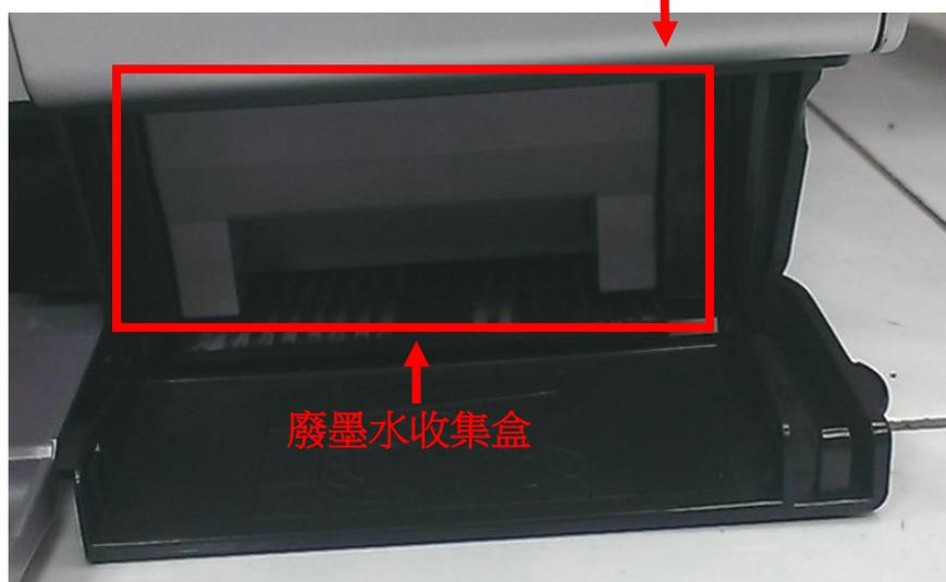
步驟 2、取出廢墨水收集盒並使用橡皮擦拭、清潔耗材晶片。
